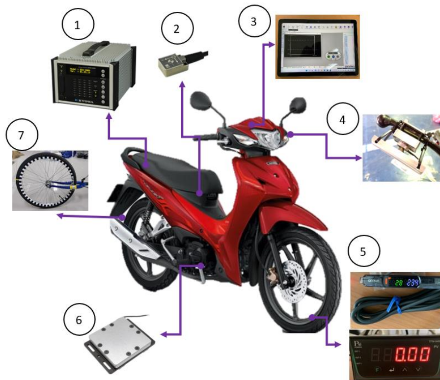
ภาพที่ 3.23 ตำแหน่งการติดตั้งอุปกรณ์ต่างๆ บนจักรยานยนต์
