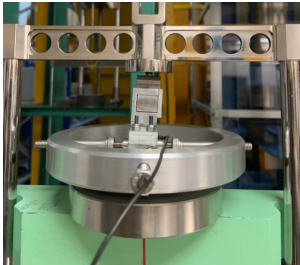
ภาพที่ 3.5 การเสียรูปของเครื่องมือวัดแรงห้ามล้อที่มีมือระหว่างการสอบเทียบ
