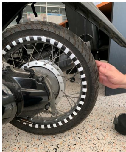
ภาพที่ 3.25 การติดตั้งสติ๊กเกอร์แถวขาวสลับดำบนล้อรถจักรยานยนต์
