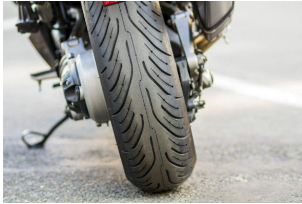
ภาพที่ 2.9 ยางล้อสำหรับรถจักรยานยนต์แบบ Sport [9]
