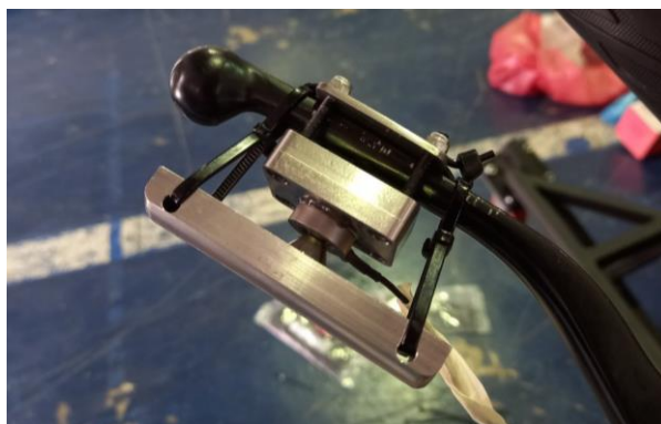
ภาพที่ 3.6 เครื่องมือวัดแรงห้ามล้อที่ได้ทำการออกแบบใหม่
