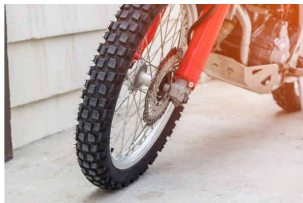
ภาพที่ 2.10 ยางล้อสำหรับรถจักรยานยนต์วิบาก [9]
