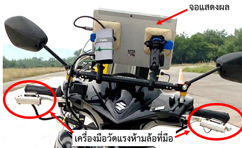
ภาพที่ 3.24 การติดตั้งเครื่องมือวัดแรงห้ามล้อที่มือบนก้านห้ามล้อมือและจอแสดงผล
