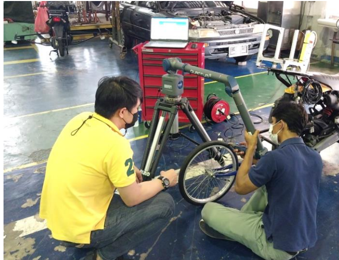
ภาพที่ 3.20 การหาเส้นผ่านศูนย์กลางล้อที่สามด้วยเครื่องมือวัดพิกัดสามมิติ
